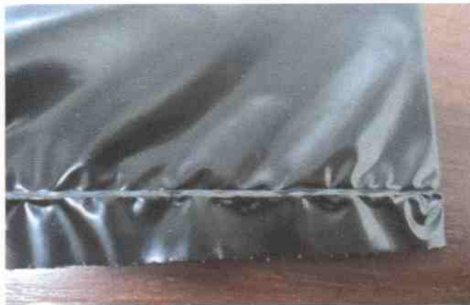
Foto 1 – Detalhe da solda "reta" no fundo
