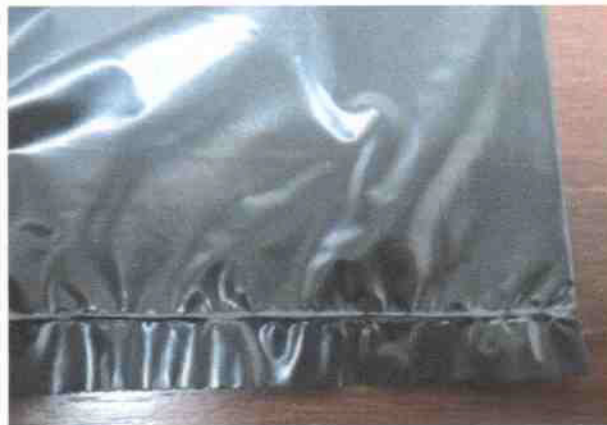
Foto 1 – Detalhe da solda “reta” no fundo
