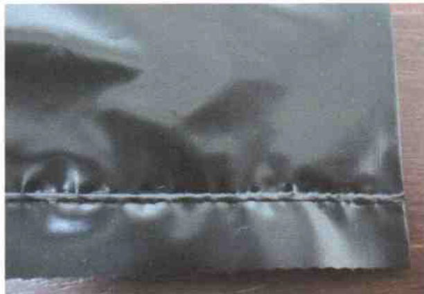
Foto 1 – Detalhe da solda "reta" no fundo
