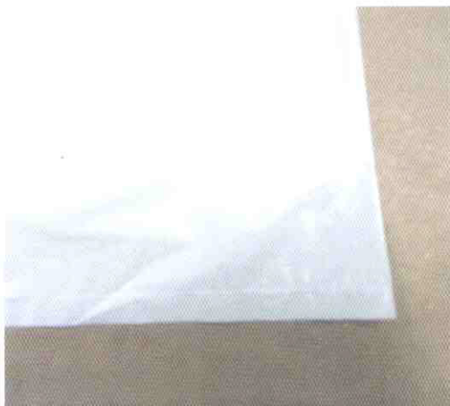
Foto 1 – Detalhe da solda “reta” no fundo
